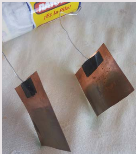
Figura 5 Placas de cobre após experimentação.
